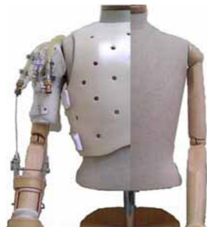
写真1 パワーアシスト装置の外観図
