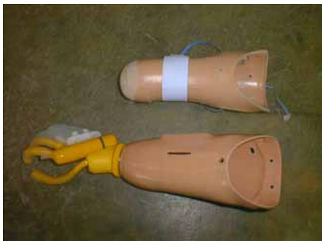
図2 筋電義手の手部とソケット
