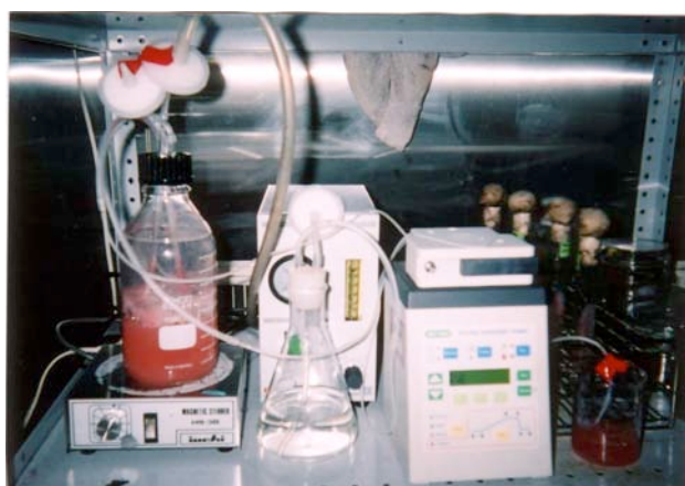
図 2 ケモスタット培養装置による HCHO 連続分解
