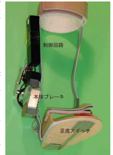
図1 装具足継手部に組み込んだMRブレーキ
