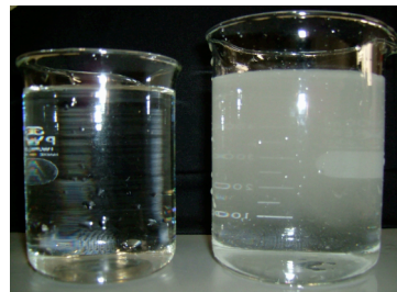
写真 2 マイクロバブル発生前の水(左)と発生後の水(右)
