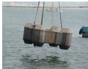
2.4 トン（左）と 5 トン(中)スラグ固化体（右）沖縄でのサンゴ着生基盤としての利用
