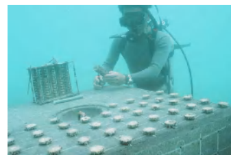
2.4 トン（左）と 5 トン(中)スラグ固化体（右）沖縄でのサンゴ着生基盤としての利用
