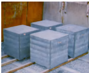
2.4 トン（左）と 5 トン(中)スラグ固化体（右）沖縄でのサンゴ着生基盤としての利用
