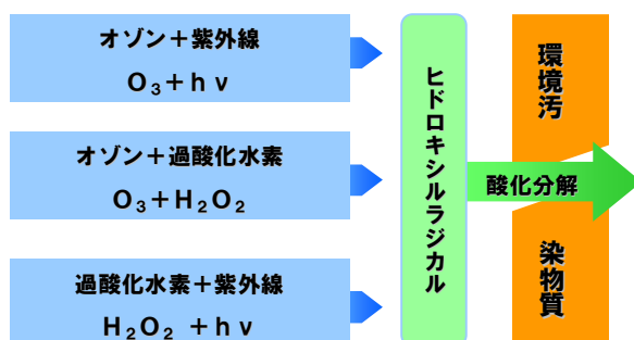
図1 ヒドロキシルラジカルによる酸化分解の概念図
