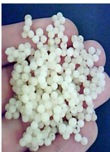
図 1 高分子粒子(粒子径1.1mm)
