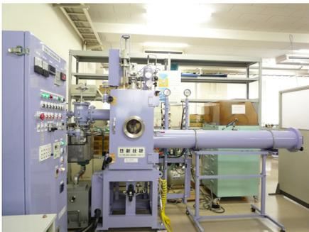
図 1. 液体急冷凝固装置
