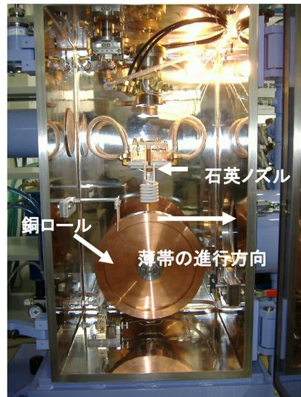
図 2. 装置本体の溶解室内部
