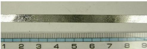
図 3. Fe<sub>75</sub>Si<sub>10</sub>B<sub>15</sub> アモルファス合金薄帯
