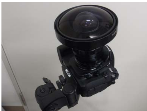
Fig.1 スカイモニターに使用する デジタル一眼レフカメラと魚眼レンズ
