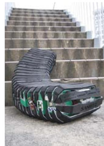
柔軟移動ロボットの実験風景 (ベルトで覆われたロボット全体が柔軟に変形し、凹凸路面や階段などを自在に移動可能)
