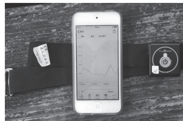
Fig.1 バイタルモニタリング装置の写真。右が人体に装着する心拍モニター（WHS-2）、左がその測定データを受信するモバイル端末。
