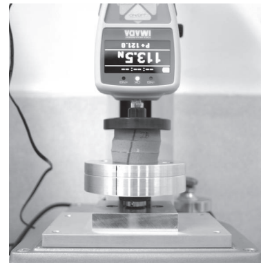
図 3 圧縮に伴うねじれ変形
