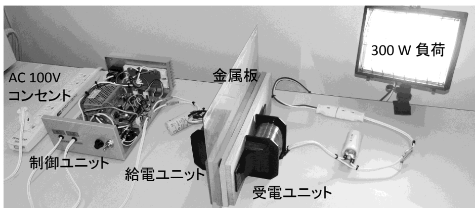
Fig.1. 金属板越しに高効率で伝送できる超低周波ワイヤレス給電システム
