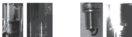
(a) エンジンシリンダ (b) 点火プラグ 図1 流速計測の対象例とレーザ照射時の迷光
