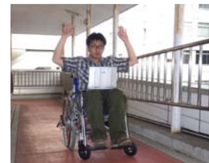
パワーアシスト車いすの実験風景 (斜路で手を離しても停止し、安全が確保される)
