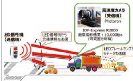
LED信号機 (or LED ブレーキランプ) と車載高速度カメラを用いた可視光通信
